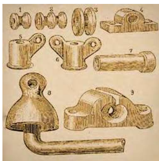
1885年高频瓷电绝缘子 (La physique moderne: l'électricité dans la maison, É.Hospitalier)
