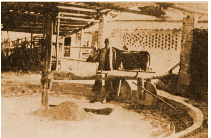
用一头牛拖动研磨机来研磨高岭土 (1939年, Viennam, 印度支那半岛经济期刊)
