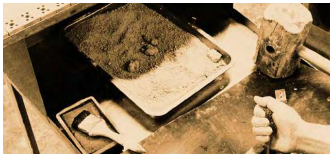
高频瓷端子接线柱手工锤子压制：手动填充湿的颗粒（私人收藏）。压制后电高频瓷的干化（私人收藏）
